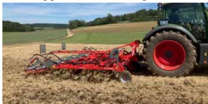
Die Güttler Großfederzahnegge in vollhydraulischer Ausrüstung: vorn die Stützräder für die Einstellung der Arbeitstiefe jetzt hydraulisch, und dazu eine Anzeige der Arbeitstiefe. Hinten die Hydrozylinder, die die beiden Striegelzinkenreihen hydraulisch einstellt.
